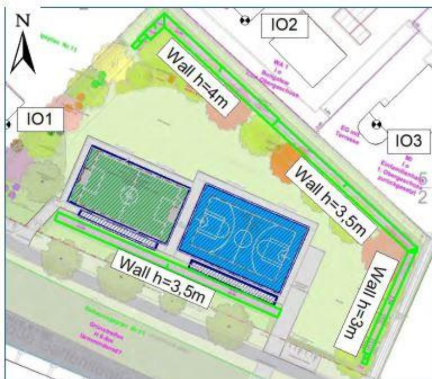
Abbildung 6 – Übersicht über die Lärmschutzwände
